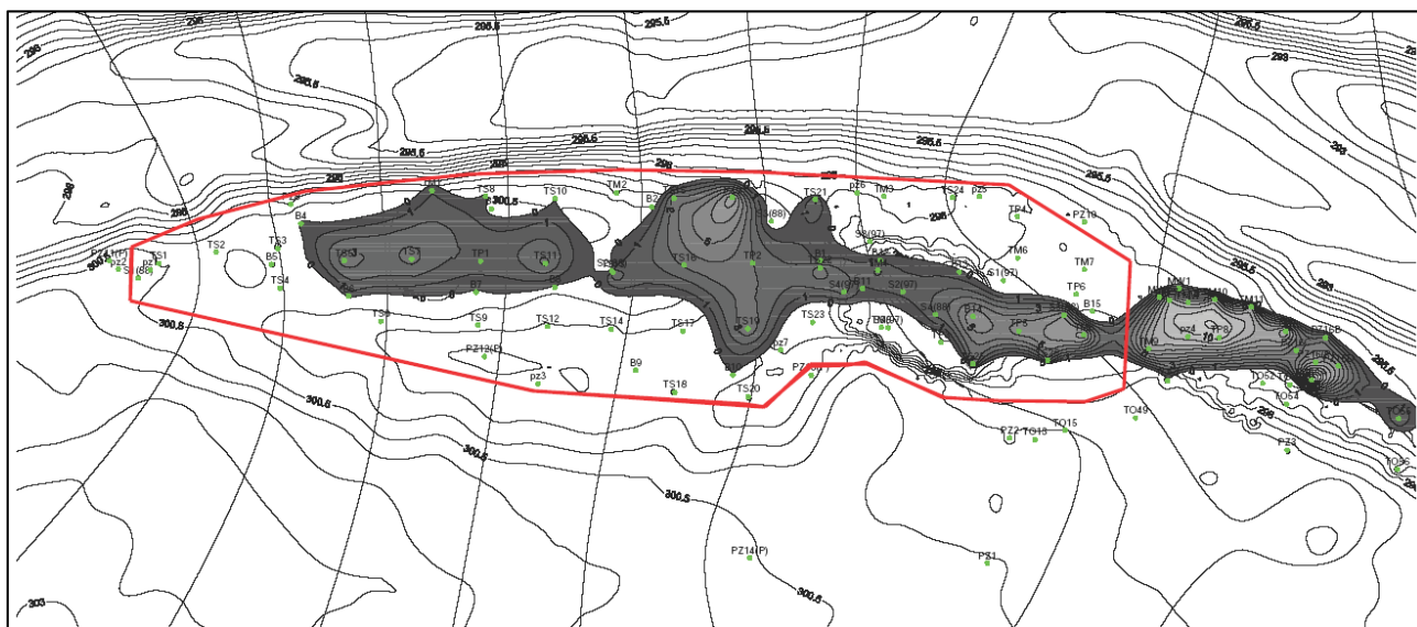
Fig. 3.1. Presenza di terreni con idrocarburi nella zona di massima escursione della falda. In rosso il confine della discarica.
