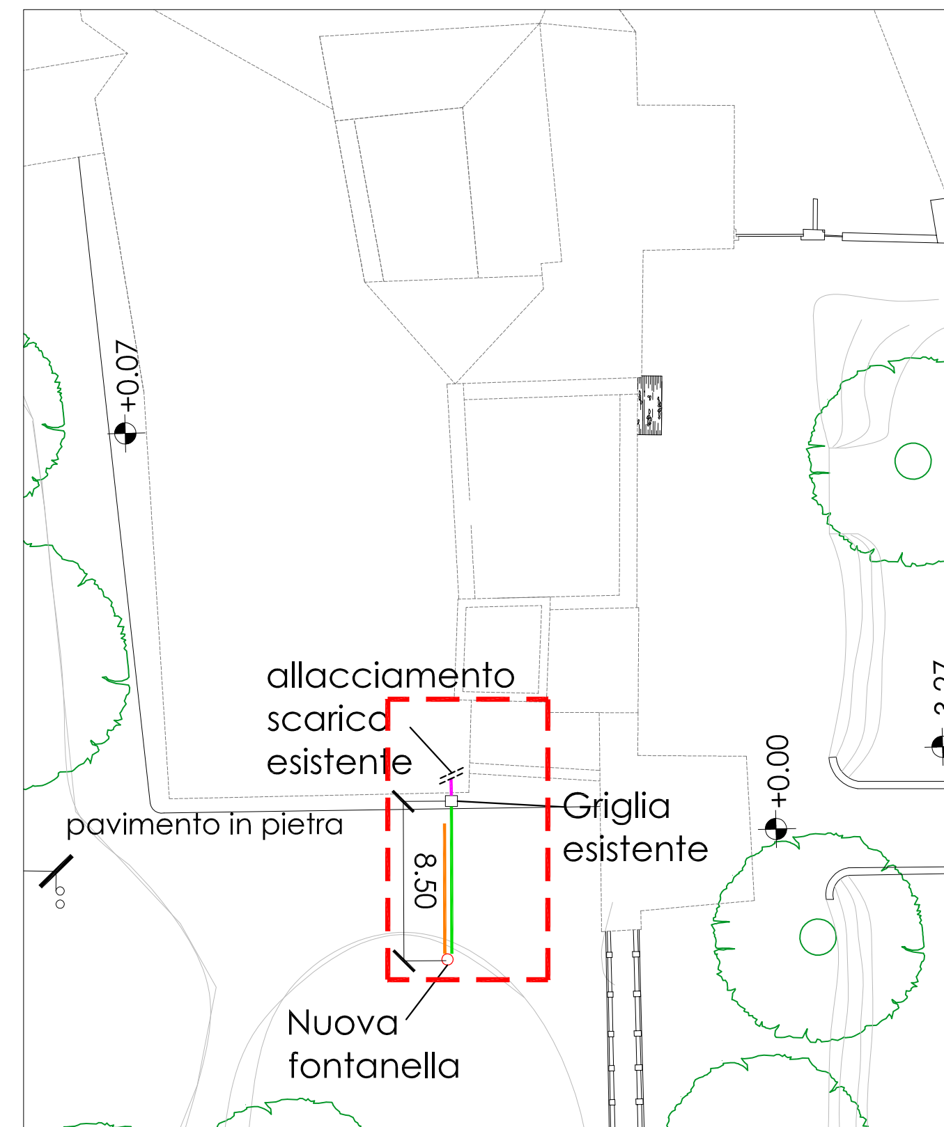
Planimetria impianto idrico Piano terreno - scala 1:250
