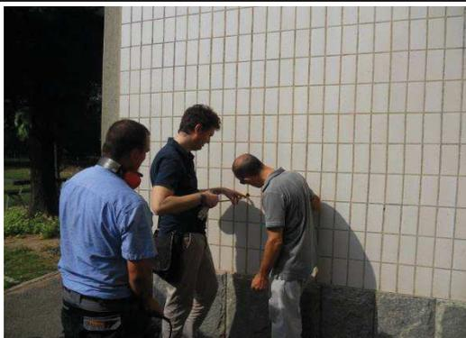
Foto 11 immagine della forometria della parete di tamponamento realizzata dall'esterno
